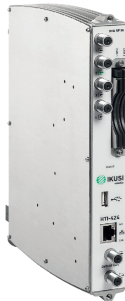
HTI-424 3863 Cuadruple transmodulateur. Reçoit les contenus de 4 transpondeurs/multiplex DVB-T/T2, DVB-S/S2, DVB-C ou IPTV, les décrypte et les transmet dans 4 canaux de sortie DVB-T ou DVB-C ou sur IPTV. Double interface commune et Connecteur Ethernet. 1 entrée + loop ou 4 entrées IP Multicast, IP Unicast Multistream supporté
