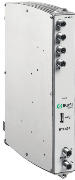
HTI-404 3864 Cuadruple transmodulateur. A pour fonction de capter quatre multiplex/transpondeurs DVB-T/T2/S/S2/C les traiter pour fournir un signal en DVB-T ou DVB-C.
